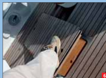
Tras las dos bitácoras, se encuentran unos pequeños registros para acceder a las mechas de ambas palas y que además sirven como calapiés cuando el barco escora.
