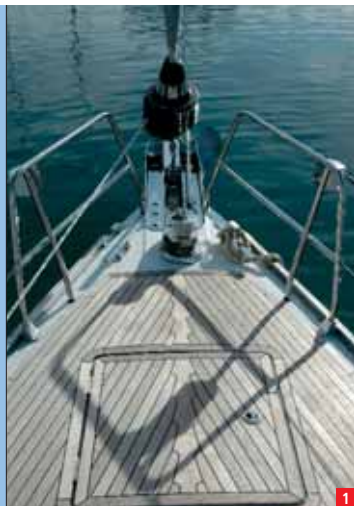
▲ La proa cuenta con un balcón semiabierto con el enrollador del génova y la maniobra de fondeo.
