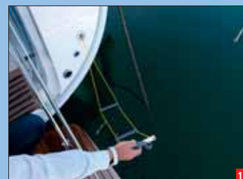
La escalera de baño de emergencia queda albergada en un pequeño cilindro con tapón a estribor del espejo de popa y accesible desde el agua.
