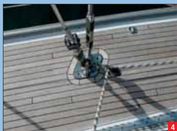
El anclaje de los obenques a cubierta sirve a su vez para instalar la polea de reenvío de la escota de la mayor con el sistema german mainsheet.
