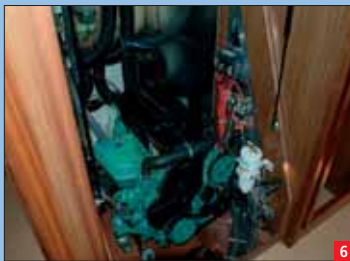
El motor probado fue un Volvo D3 de 110 CV con acceso bajo la escalera y en los laterales de los camarotes de popa.
