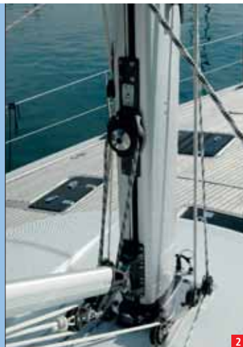
Las drizas son reenviadas desde el pie de mástil bajo una tapa que recorre la cubierta del roof hasta el piano.
